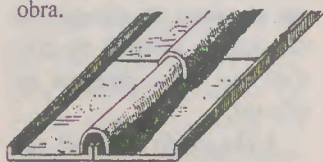
Pormenor de um telhado romano
