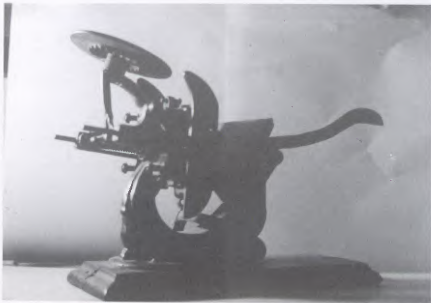
Maquineta de imprimir cartões de visita. Marca: Bremen. Funcionou em 1886 na Tipografia Espozendense de José da Silva Vieira.
