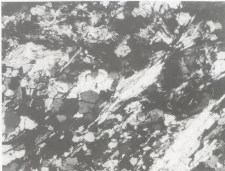
Fig. 28 — Corneanas pelíticas da zona da silimanite. Textura granoblástica. Mineralogia constituída por quartzo-moscovite-biotite-silimanite. Silimanite em secções alongadas. Luz pol. Nic+(X4).
