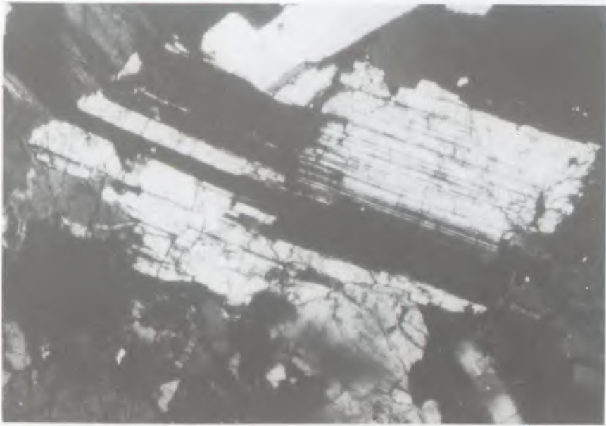
Fig. 36 — Fracturação da plagioclase no granito cisalhado de Faro. Luz pol. Nic+(X4).
