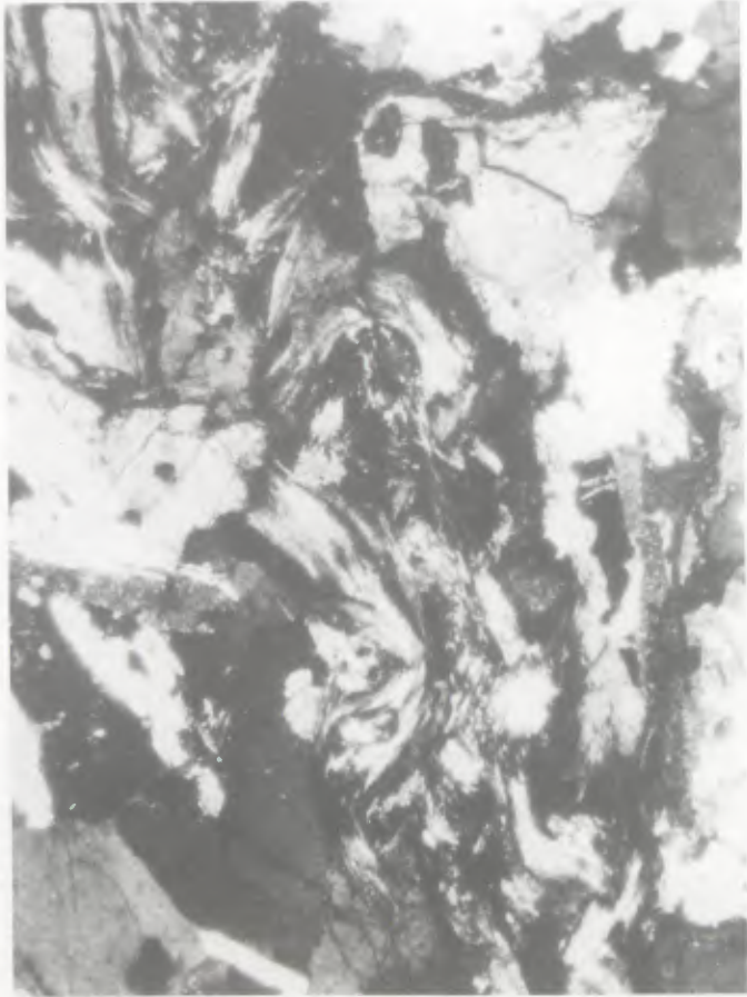
Fig. 30 — Corneana pelítica . Silimanite em feixes contorcidos, contendo estes no interior restos de biotite. Luz pol. Nic+(X4).
