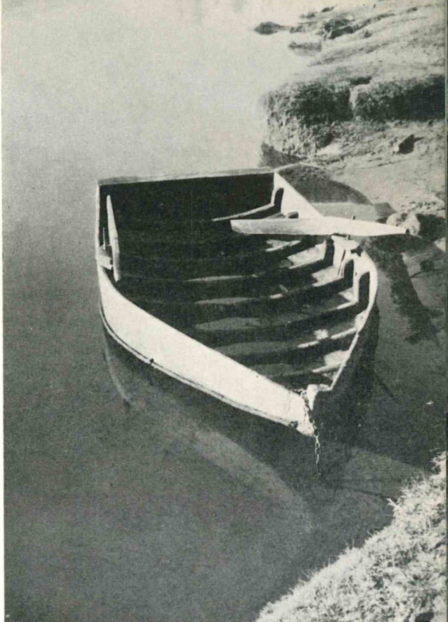
Fig. 16 — O barco de Quintão . Foi a embarcação mais primitiva que encontramos . Não possui capeados, nem bordões, nem lémio .
