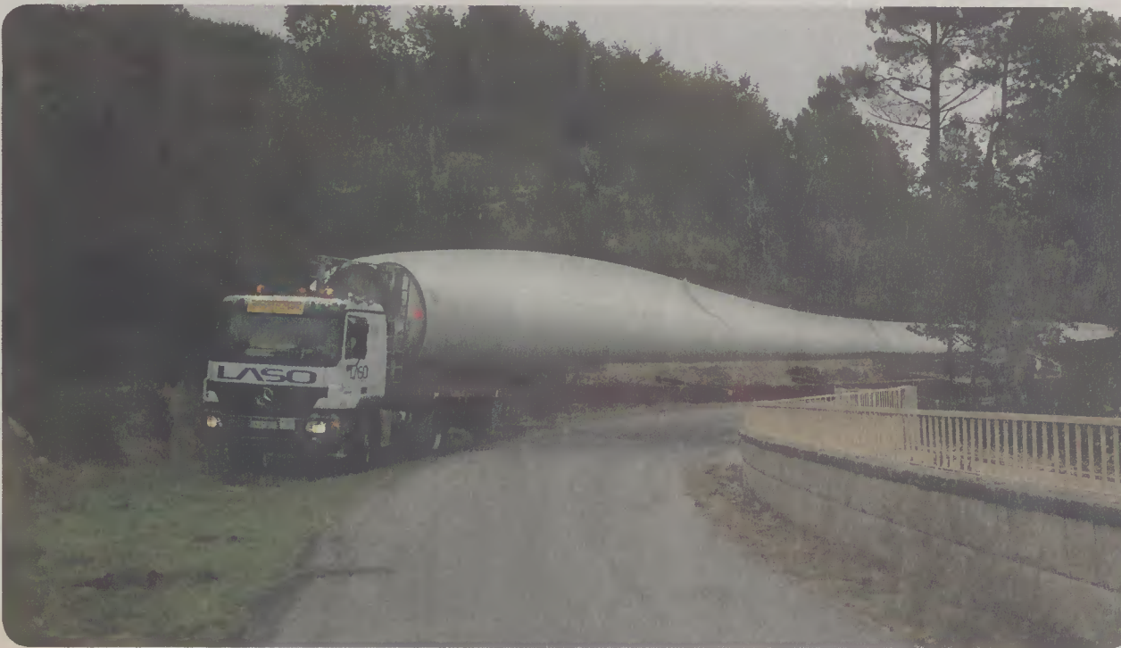
Transporte de Pás para o sobreequipamento
